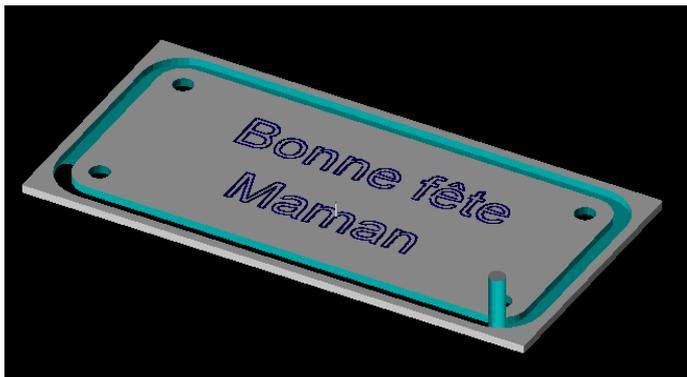
Ce fichier FAO est transmis au module **PILOTE** de la machine : l'usinage peut avoir lieu. Mais on pourra choisir d'abord une **SIMULATION** sur l'écran avant de procéder à l'usinage
