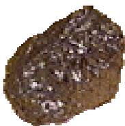
Photographie du silicium, élément semi-métallique et très conducteur servant dans la construction des transistors
