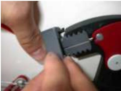
Déclipper le **contre écrou** en pinçant ses 2 pattes
