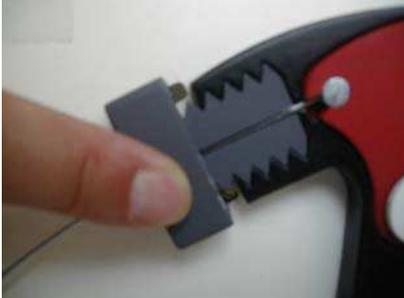
Clipper le **contre écrou** en l'enfonçant dans les deux entailles
