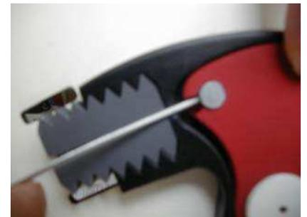
Introduire le **câble** dans la rainure de l'**écrou de réglage**
