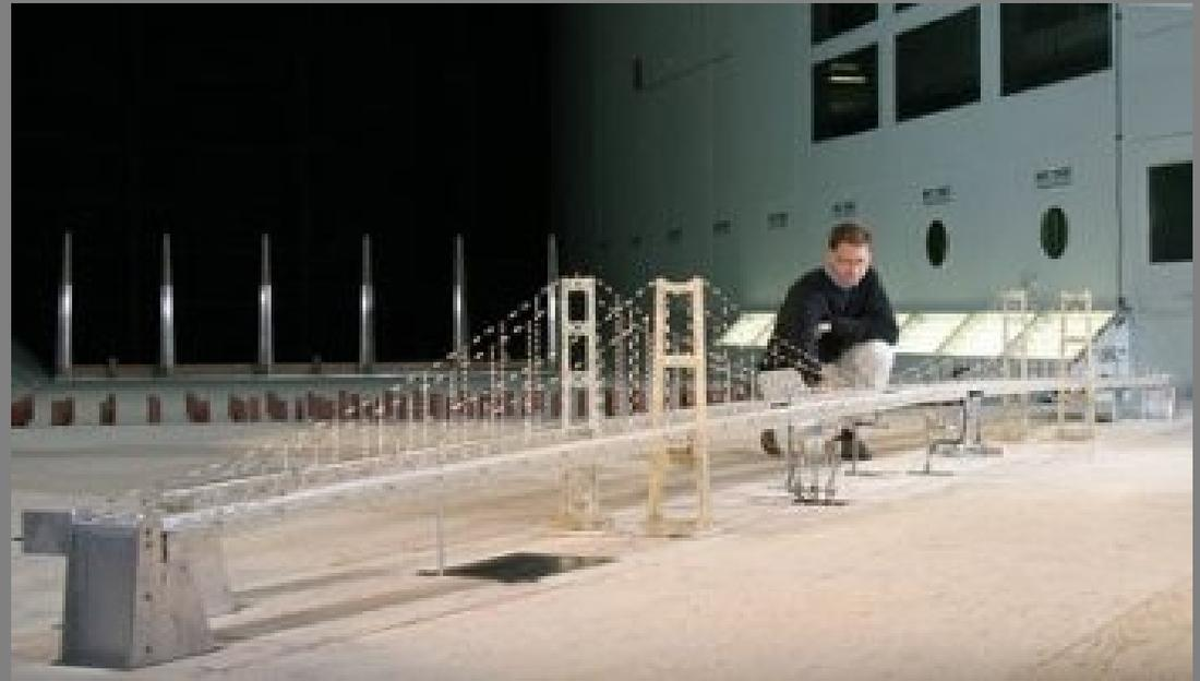
Mise en place d'une maquette de pont dans une soufflerie de laboratoire en vue de procéder à des essais.
