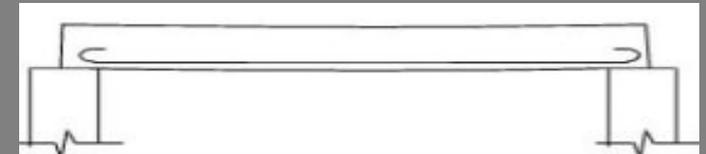
Poutre en béton armé reposant sur deux appuis, légèrement incurvée vers le bas sous l'effet de son propre poids
